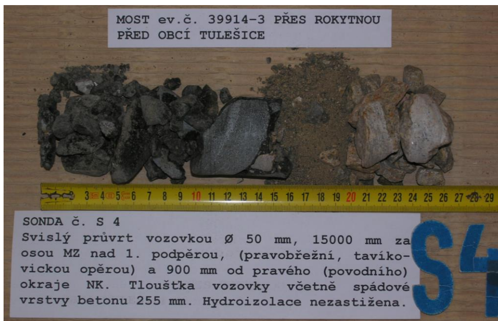
Obr.G47-100 Sonda č.S4. Svislý průvrt vozovkou Ø 50 mm, 15000 mm za osou MZ nad 1. podpěrrou, (pravobřežní, tavíkovickou opěrou) a 900 mm od pravého (povodního) okraje NK. Tloušťka vozovky včetně spádové vrstvy betonu 255 mm. Hydroizolace nezastižena.
