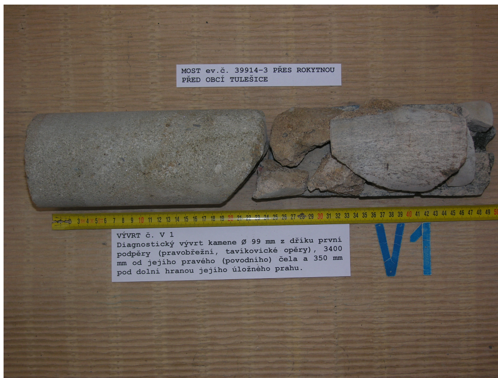
Obr. G47-101 VÝVRT č. V1. Diagnostický vývrt kamene Ø 99 mm z dříku první podpěry (pravobřežní, tavíkovické opěry), 3400 mm od jejího pravého (povodního) čela a 350 mm pod dolní hranou jejího úložného prahu.
