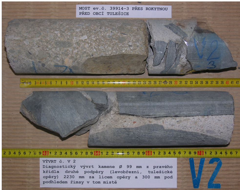
Obr. G47-102 VÝVRT č. V2. Diagnostický vývrt kamene Ø 99 mm z pravého křídla druhé podpěry (levobřežní, tulešické opěry) 2230 mm za lícem opěry a 300 mm pod pohledem římsy v tom místě.
